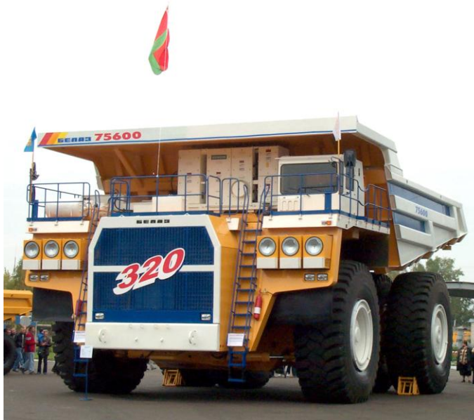
Карьерный самосвал БелАЗ-75600 грузоподъемностью 320 тонн
