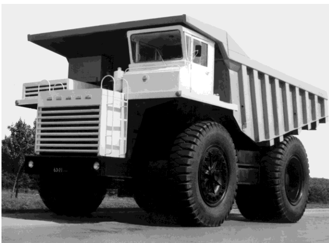
Карьерный самосвал БелАЗ-549 грузоподъемностью 75 тонн
