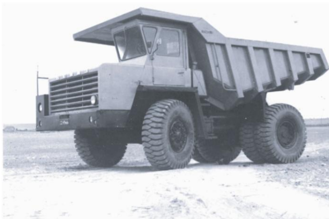
Карьерный самосвал БелАЗ-540 грузоподъемностью 27 тонн
